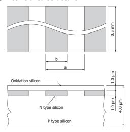
S3902 series:  $a=50~\mu m$ ,  $b=45~\mu m$  S3903 series:  $a=25~\mu m$ ,  $b=20~\mu m$
